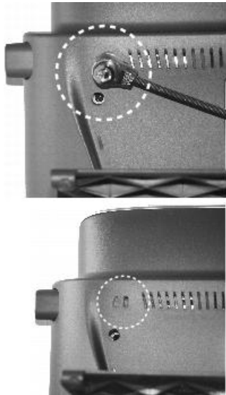
그림 1: Cisco Unified IP Phone에 케이블 자물쇠 연결
